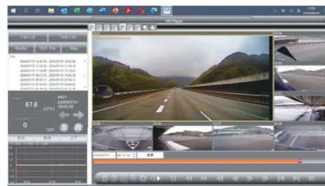
車速・エンジン回転数・ウインカー・ブレーキ・バック・その他多数の信号を車両より取得することができます。
